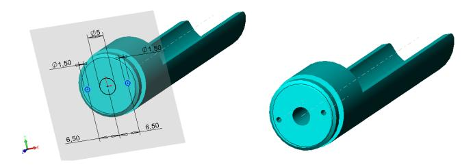
Créér un plan décalé de 10 mm par rapport au plan XZ
