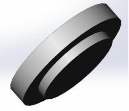
Sélectionner la face du dessus puis réaliser un perçage (diamètre 5,5 mm profondeur 15 mm ) avec un Mole Wizard... lamage (diamètre 9 mm et profondeur 5 mm )
