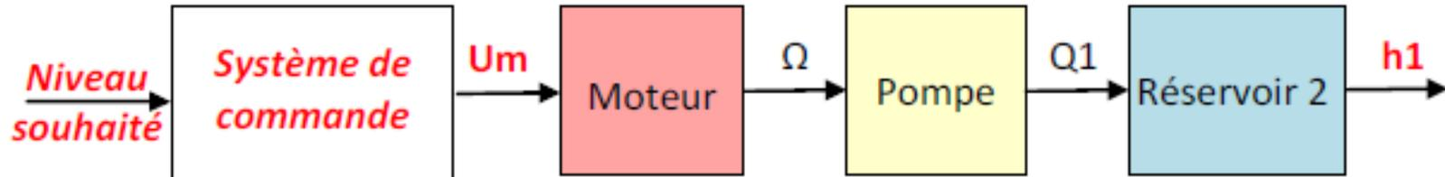
Figure 2 : Mise en place d'un système de commande
