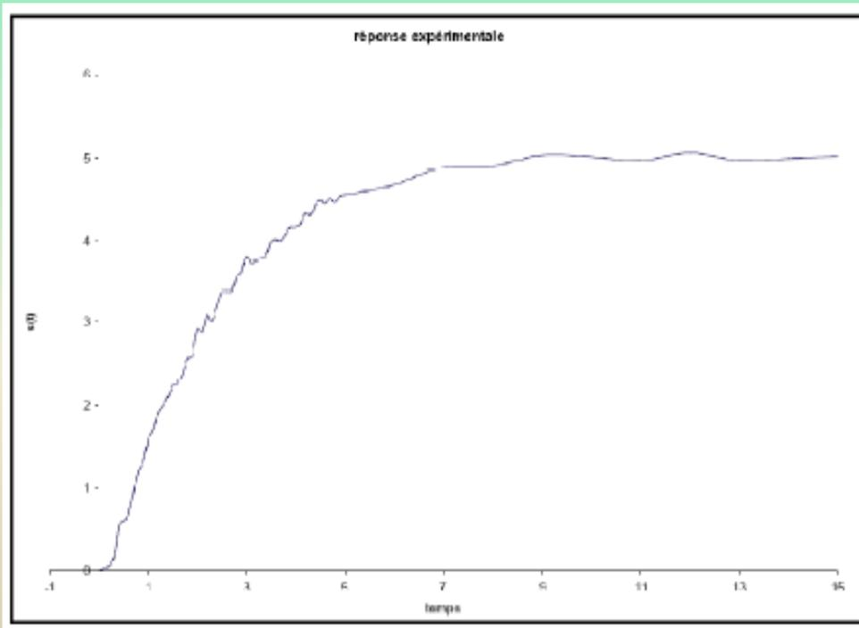
Nous constatons une réponse apériodique avec une pente à l'origine nulle et aucun dépassement. Nous adoptons pour ces raisons le modèle suivant :
