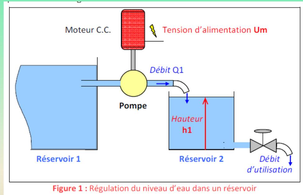
L'alimentation du réservoir 2 est assurée par une pompe actionnée par un moteur à courant continu commandé par une tension d'alimentation  $U_m$ .
