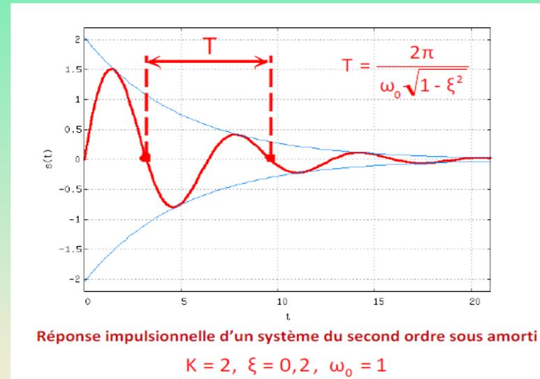
Lorsqu'il n'y a pas d'amortissement ( $\xi = 0$ ), on a une réponse sinusoidale de pulsation  $\omega_0$  : on retrouve la réponse de l'oscillateur harmonique
