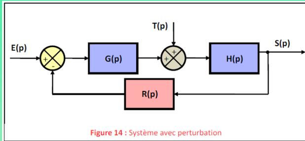
Figure 14 : Système avec perturbation
