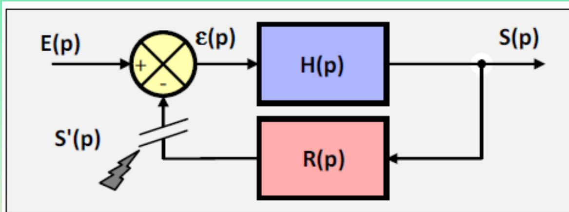
On définit la Fonction de Transfert en Boucle Ouverte (FTBO) comme le rapport entre l'image de la sortie  $S'(p)$  et l'écart  $\varepsilon(p)$  :
