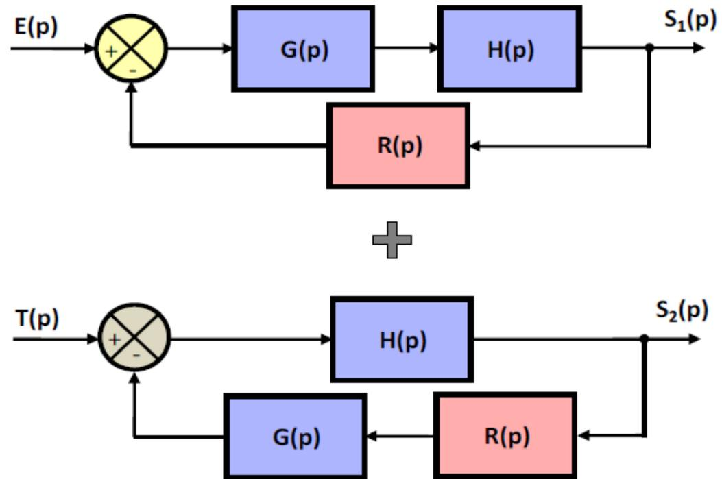
Figure 15 : Application du principe de superposition
