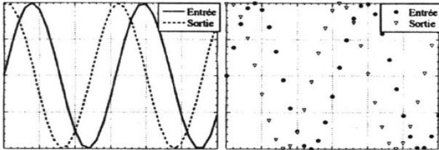
**Figure 11 : Système continu (à gauche) et système discret (à droite)**
