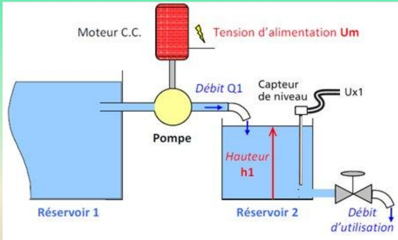
Un capteur de mesure de la hauteur d'eau a été rajouté
