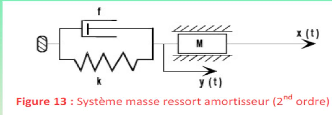
En appliquant le Principe Fondamental de la Dynamique a la masse M, nous obtenons l'équation différentielle du second ordre:
