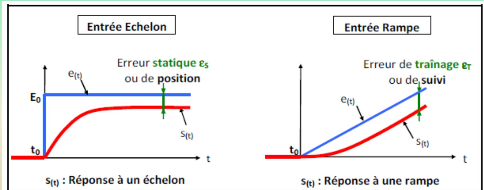
Figure 5 : Précision d'un système asservi
