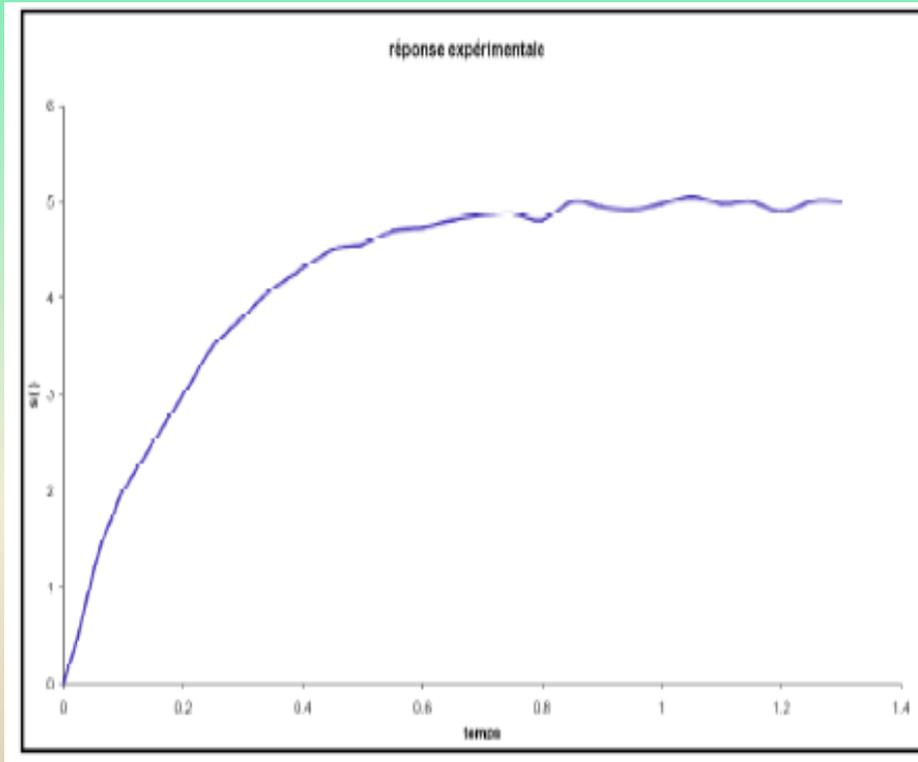
Nous constatons une pente à l'origine non nulle et aucun dépassement de la réponse. Nous adoptons pour ces raisons le modèle suivant du premier ordre :
