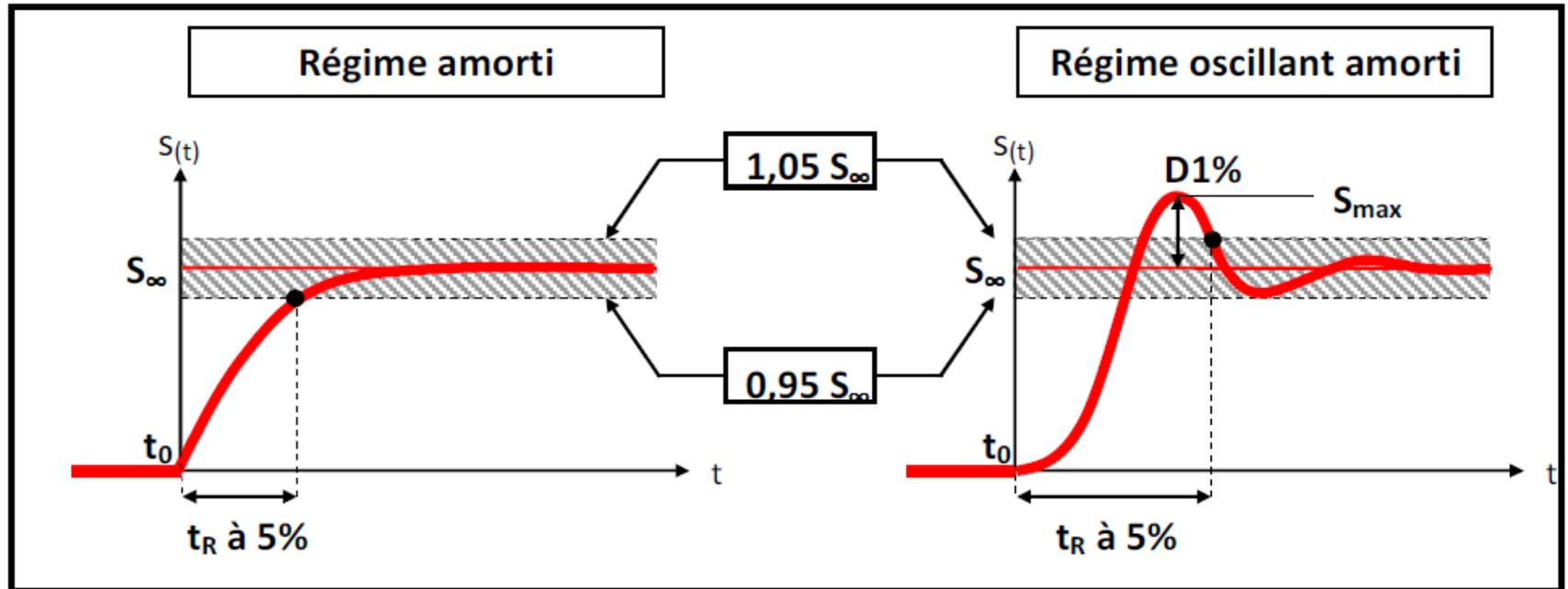
Figure 6 : Rapidité d'un système asservi
