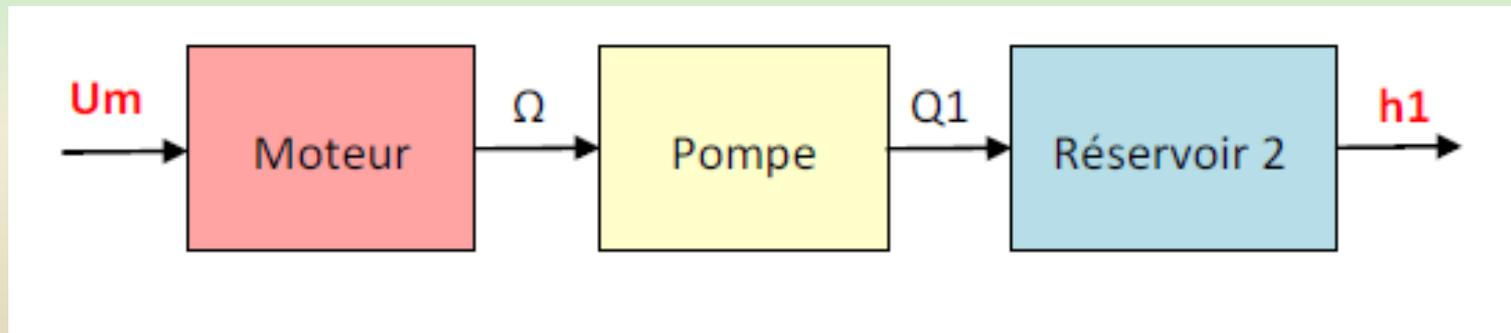
Les grandeurs physiques ( $U_m$ ,  $\Omega$ ,  $Q_1$  et  $h_1$ ) sont ici des fonctions du temps.
