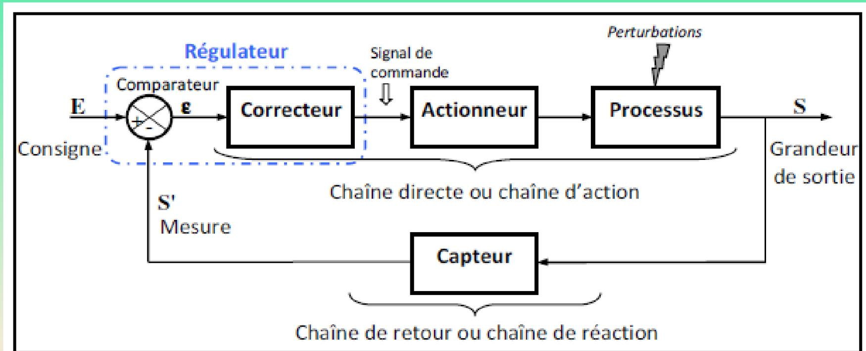
Figure 4 : Structure générale d'un système asservi
