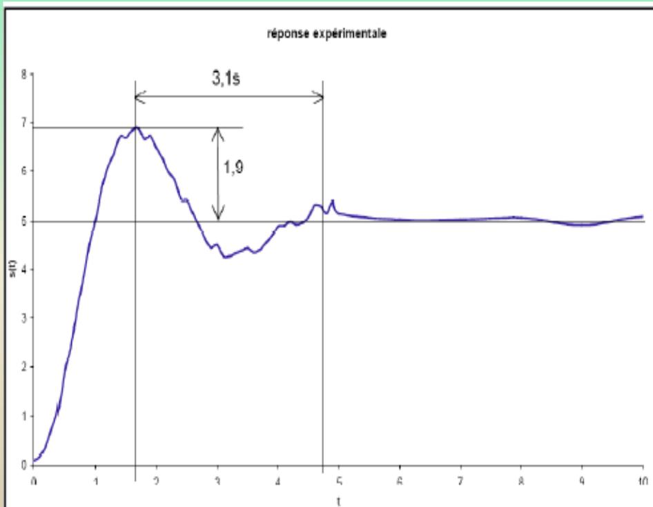
Nous constatons une **réponse pseudo périodique** avec une **pente à l'origine nulle** et des **dépassements** de la réponse. Nous adoptons pour ces raisons le modèle suivant :
