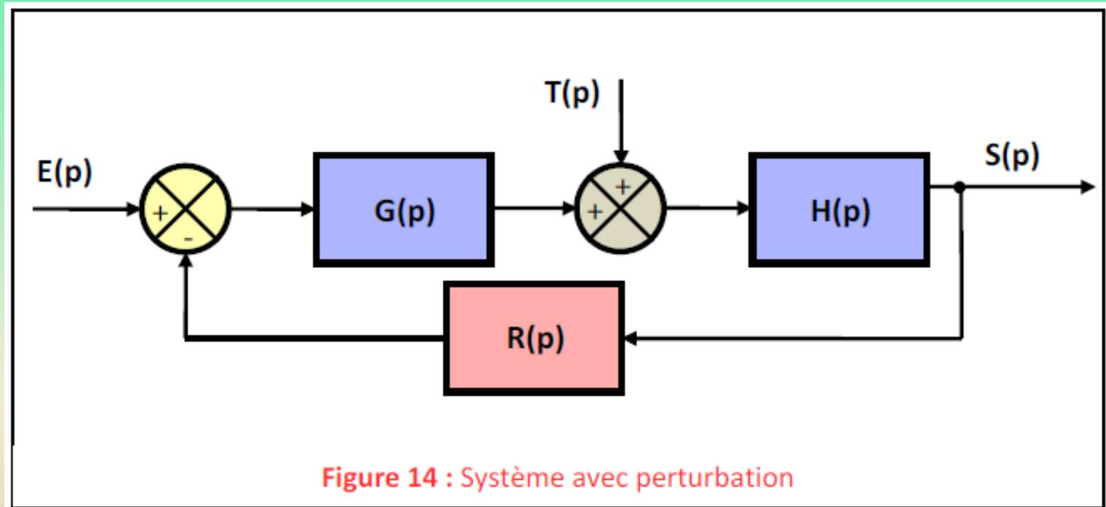
Figure 14 : Système avec perturbation
