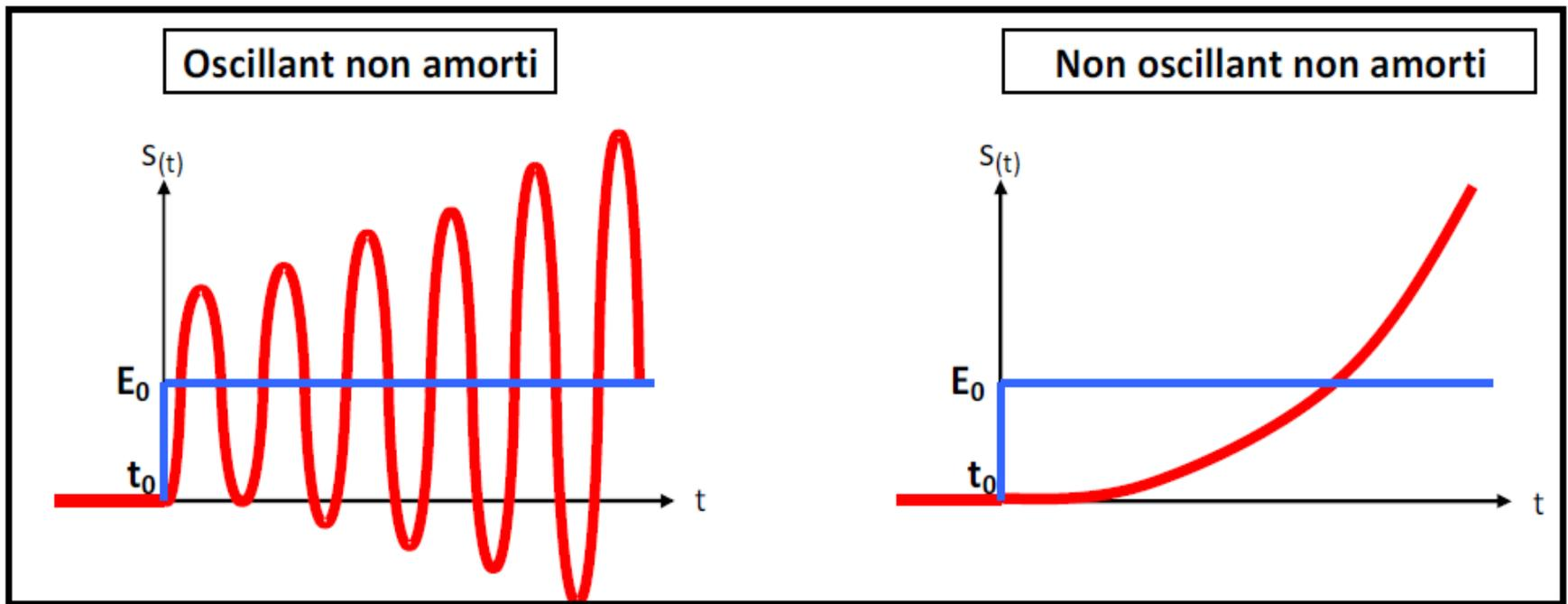
Figure 7 : Réponses caractéristiques de systèmes instables
