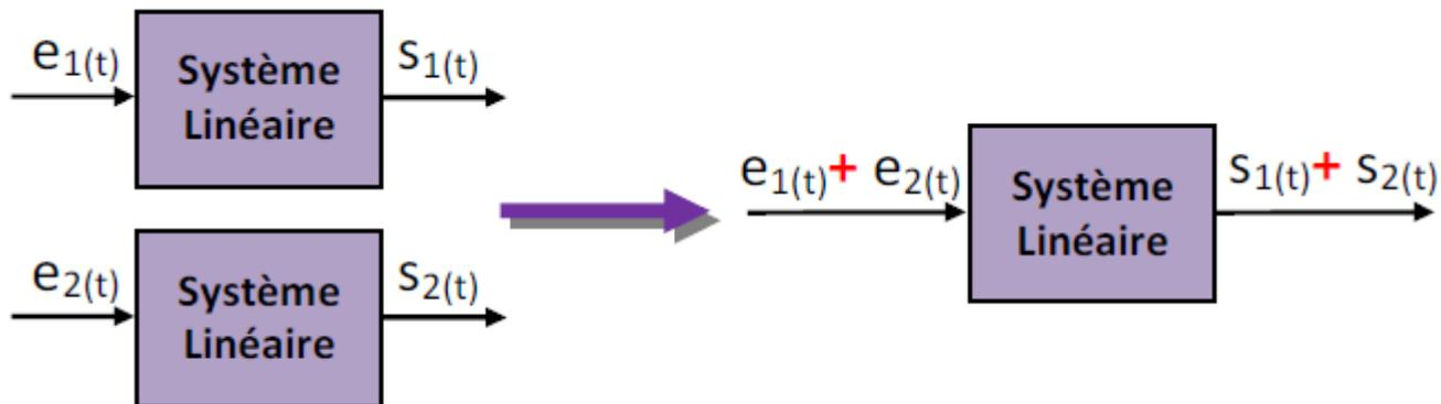
Figure 10 : Principe de superposition.
