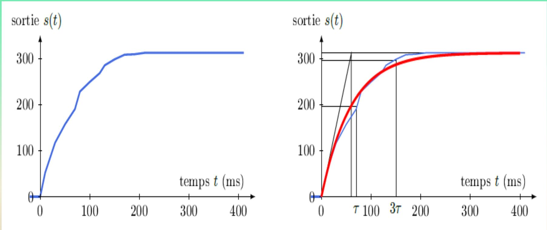
Figure 2 Identification d'un modèle de comportement d'un système du premier ordre
