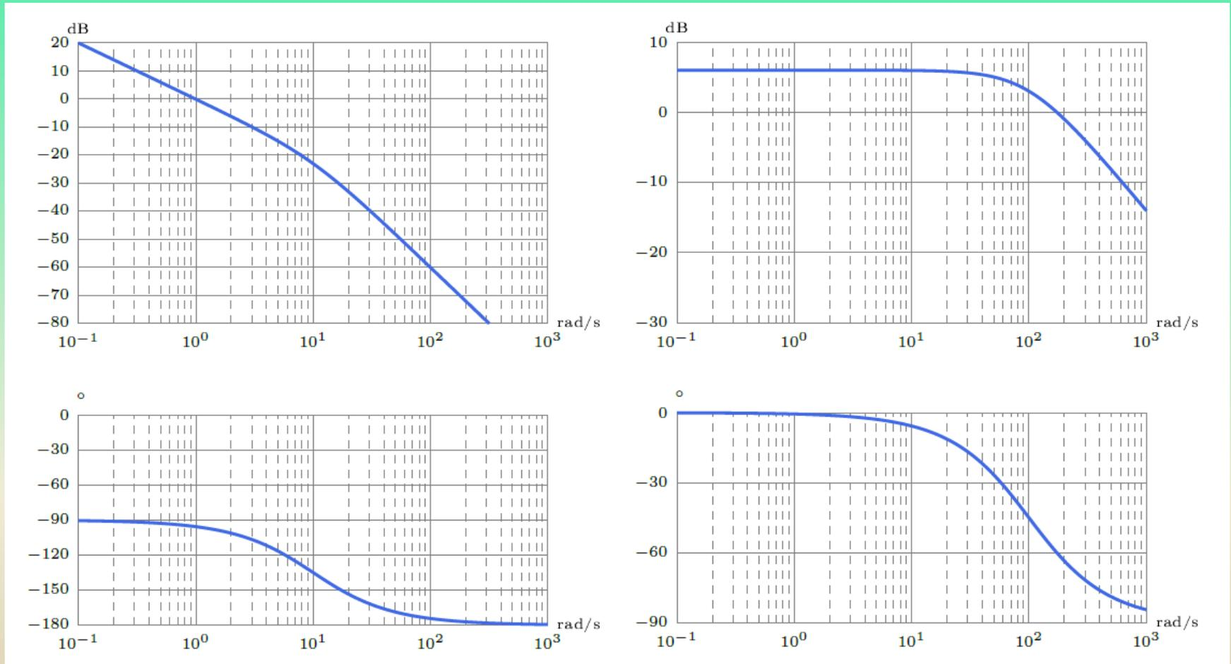
Systèmes précis et non précis dans le domaine fréquentiel (plan de Bode)
