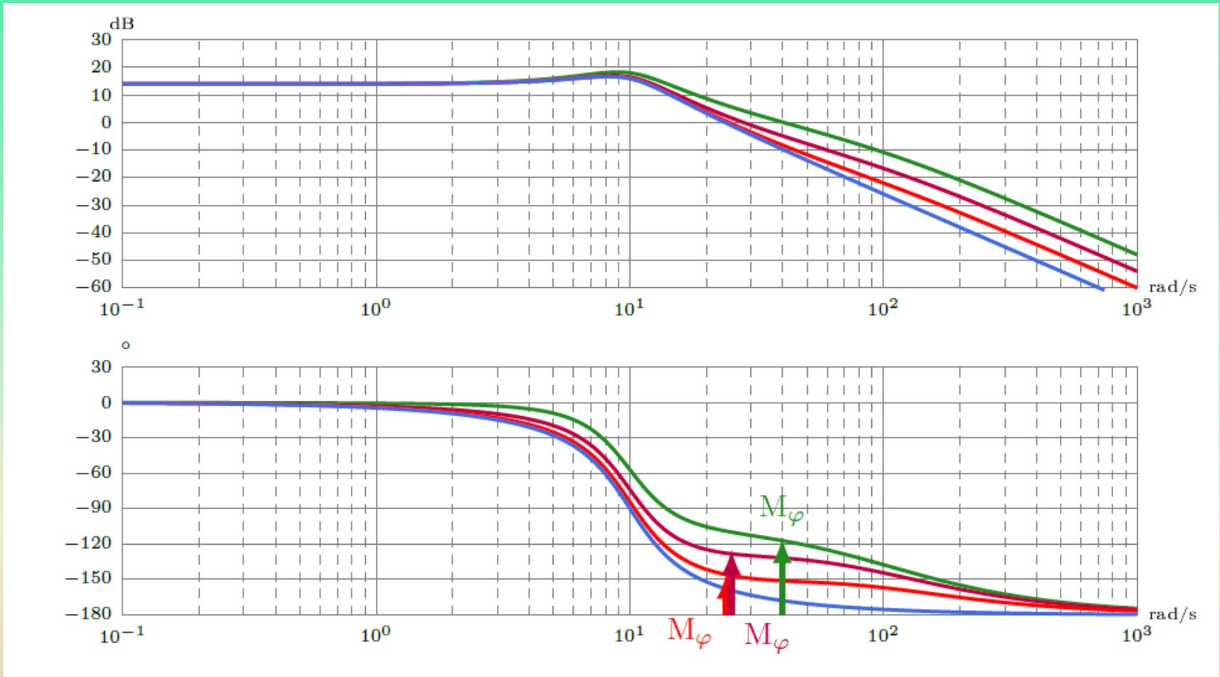
*Figure 35 Influence d'un correcteur à Avance de Phase sur la stabilité (plan de Bode)*
