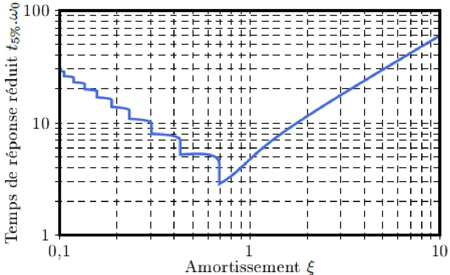
Figure 17 - Abaque du temps de réponse réduit
