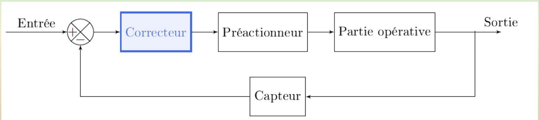
*Schéma-blocs d'un système avec bloc Correcteur*
