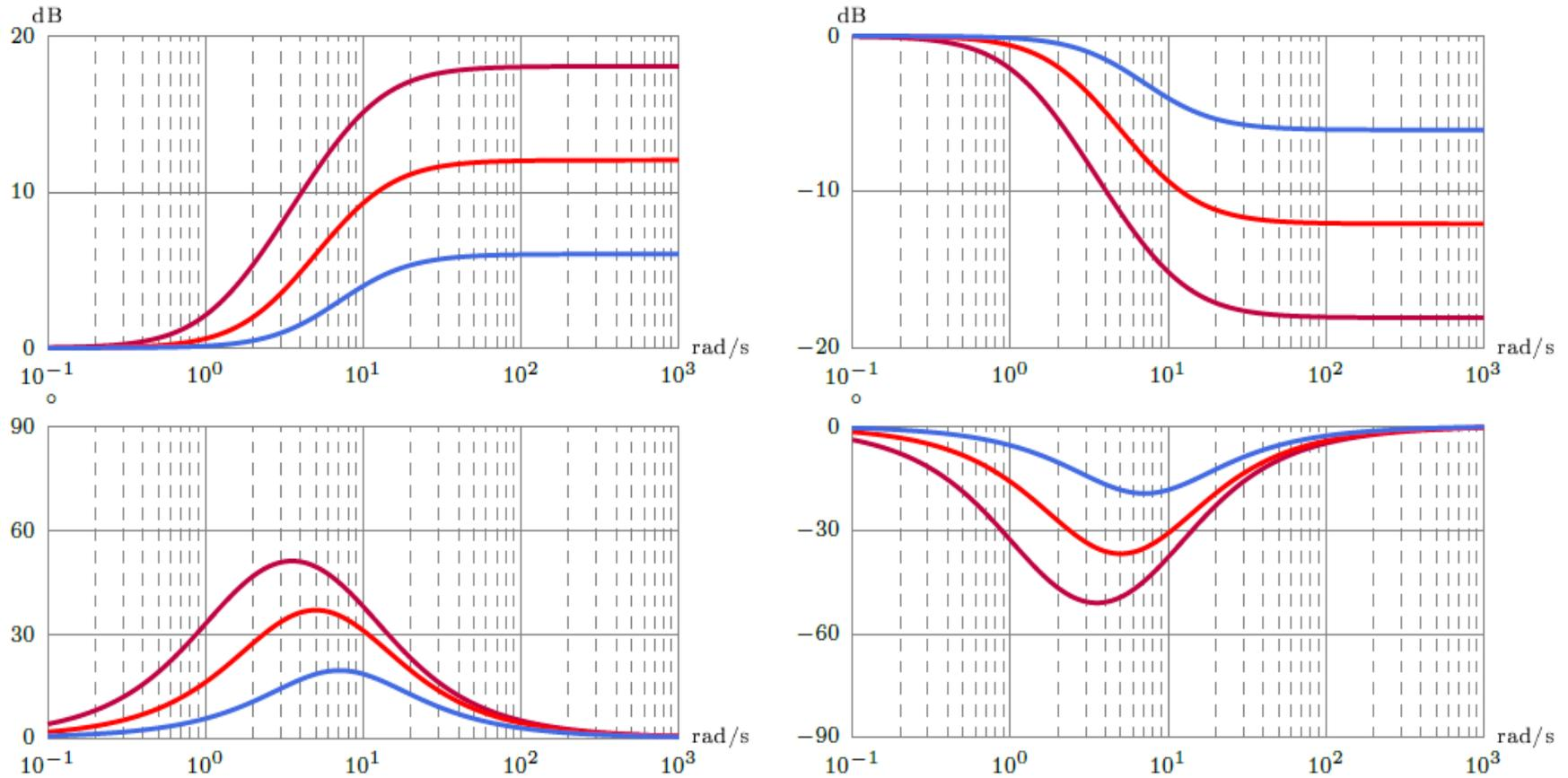
*Figure 34 Diagrammes de Bode de correcteurs à Avance et Retard de Phase en fonction de  $a$*
