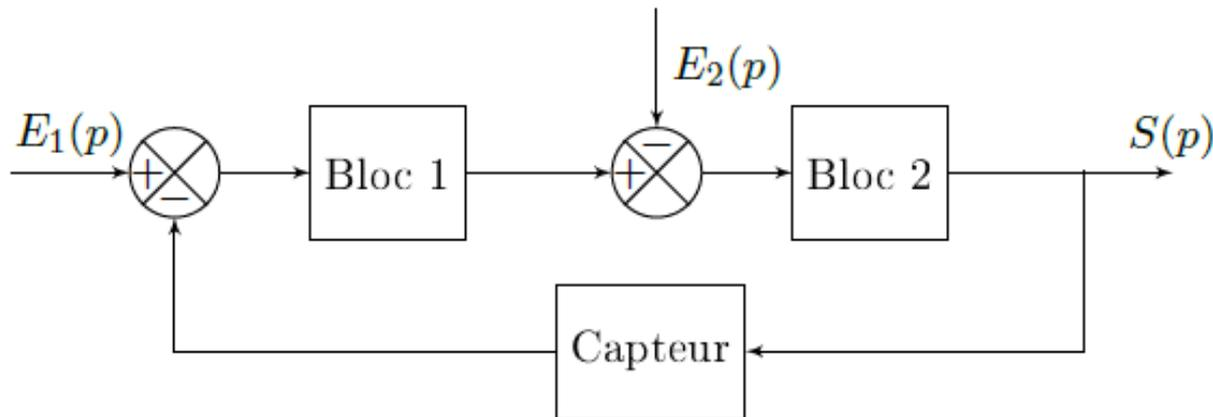
FIGURE 1 – Schéma-blocs fonctionnel d'un système à 2 entrées et 1 sortie
