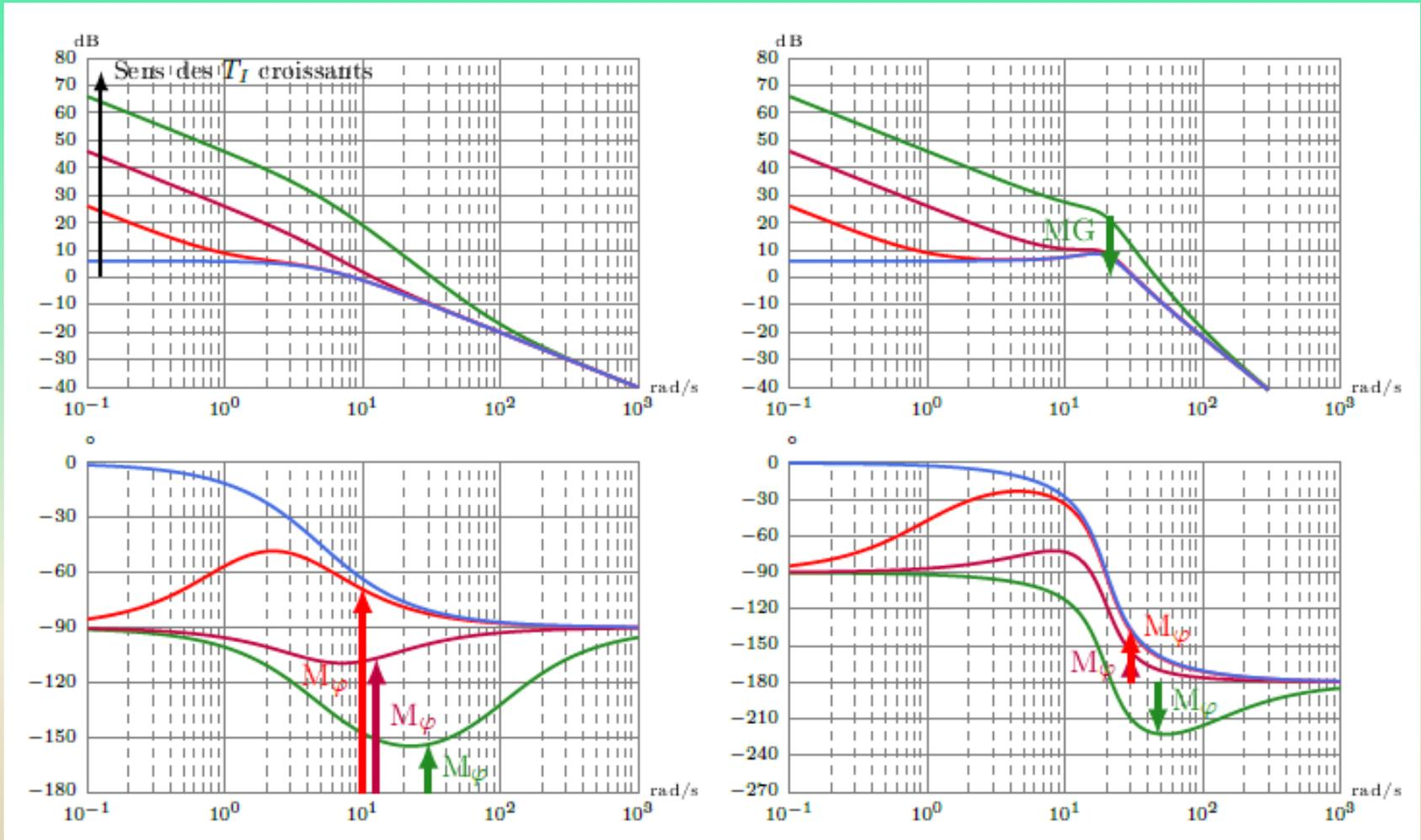
Figure 26 Influence d'un correcteur PI sur le diagramme de Bode de la boucle ouverte à  $K_I$  fixé
