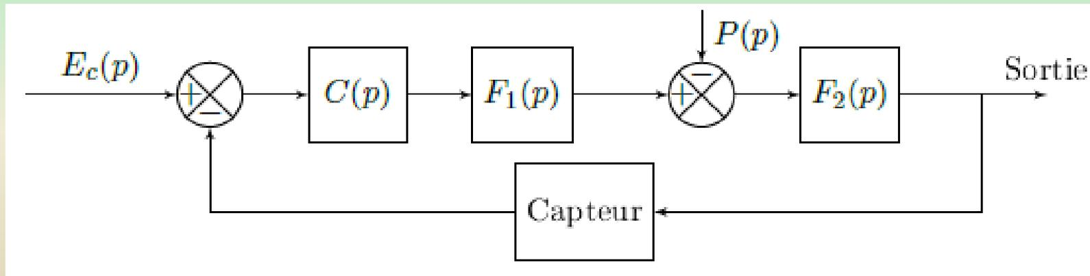
Figure 28 Schéma-blocs d'un système avec bloc correcteur et perturbation
