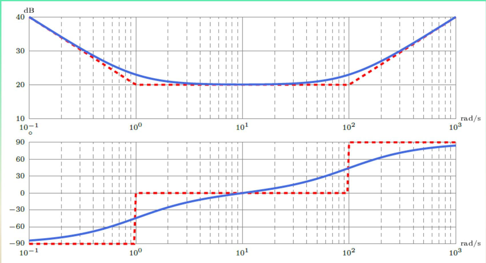
*Figure 32 Diagramme de Bode d'un correcteur Proportionnel Intégral Dérivé*
