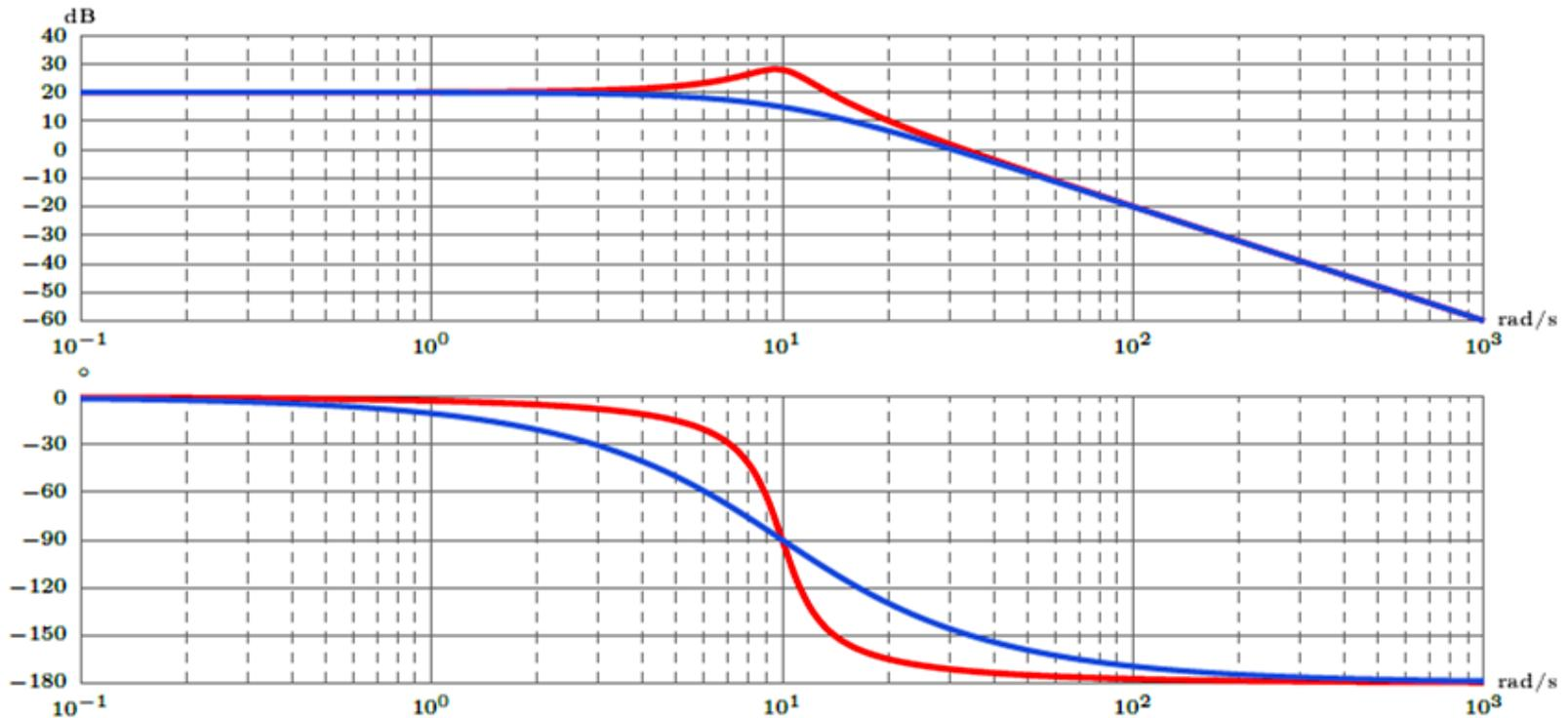
FIGURE 9 – Diagrammes de Bode d'un système du second ordre avec  $\xi$  inférieur et supérieur à  $\frac{\sqrt{2}}{2}$
