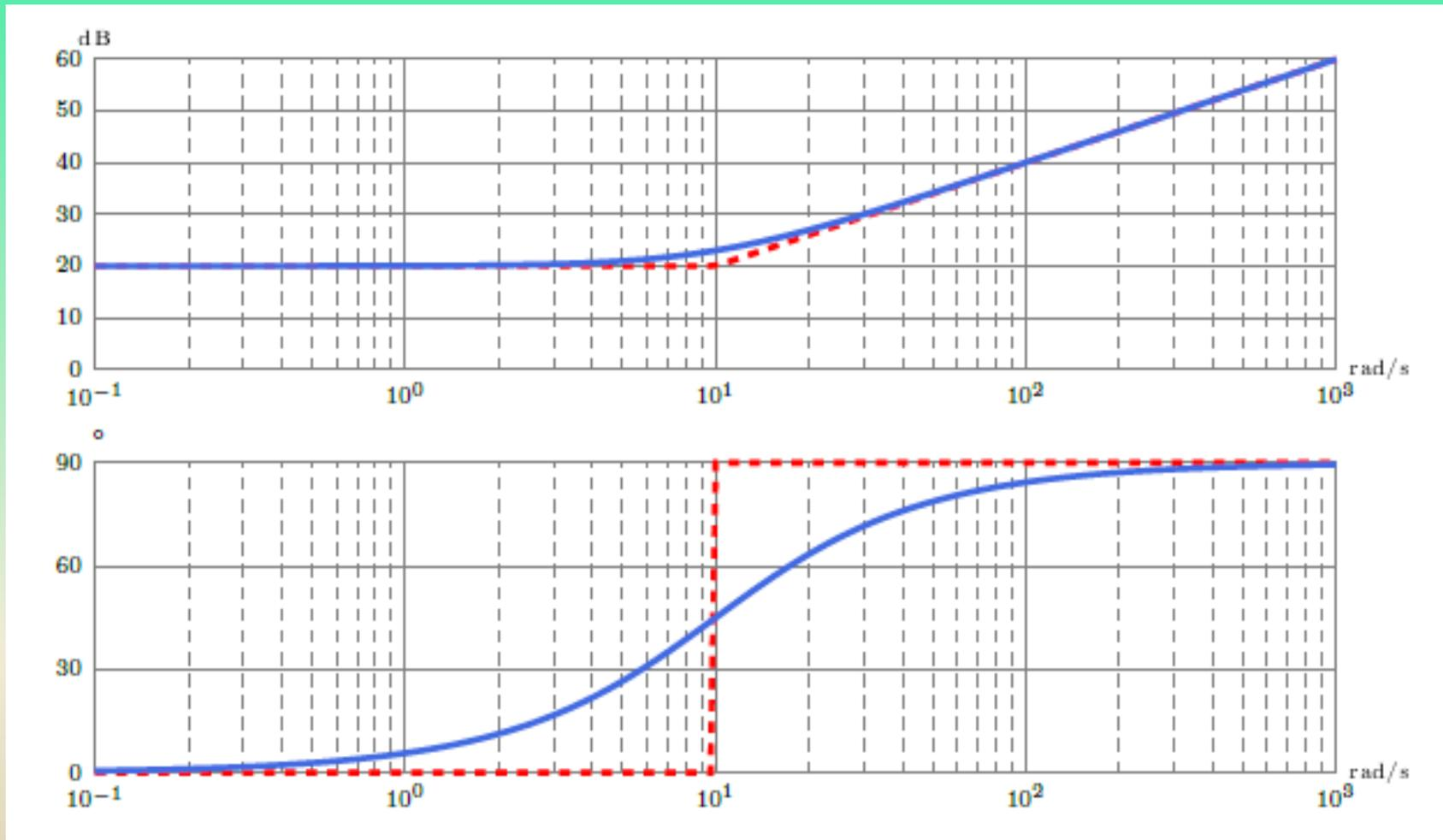
*Figure 29* Diagramme de Bode d'un correcteur Proportionnel Dérivé
