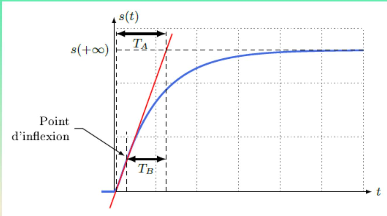
Figure 3 Identification d'un modèle de comportement d'un 2<sup>e</sup> ordre sans dépassement
