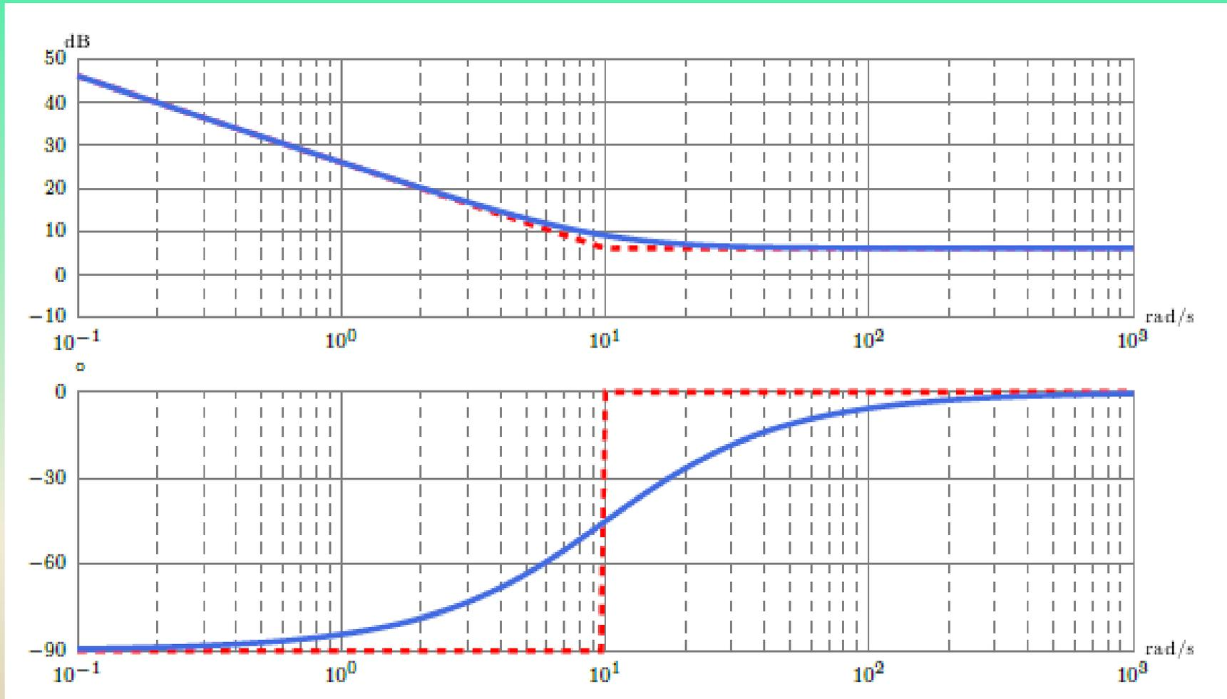
*Figure 25* Diagramme de Bode d'un correcteur Proportionnel Intégral
