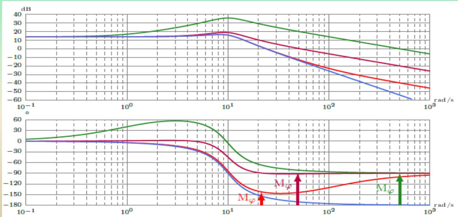
Figure 30 Influence d'un correcteur Proportionnel Dérivé sur la stabilité
