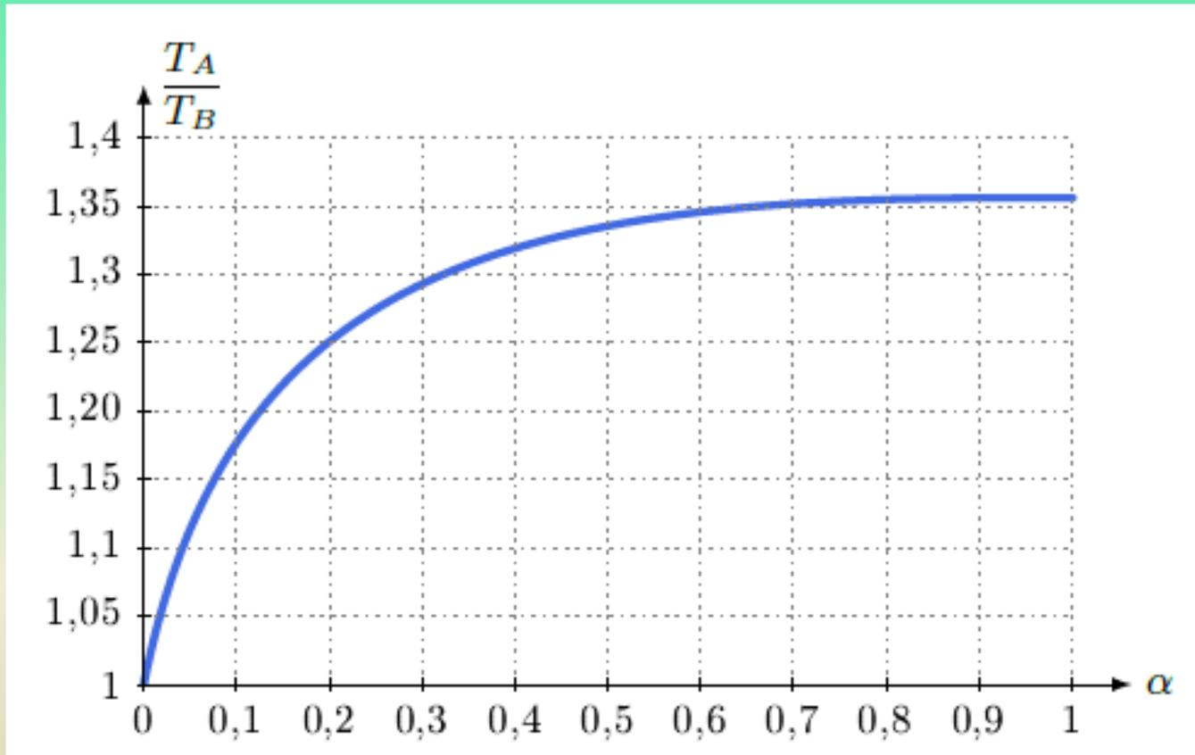
Figure 4 Abaque de Strejc-Broïda d'un système du second ordre sans dépassement
