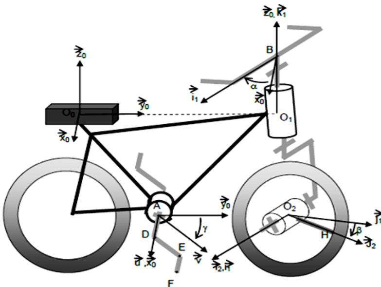
$$\begin{aligned} \vec{O_0A} &= a \cdot \vec{y_0} - b \cdot \vec{z_0} \\ \|\vec{O_0O_1}\| &= l \\ \|\vec{O_1B}\| &= h \\ \|\vec{O_1O_2}\| &= q \\ \|\vec{O_2H}\| &= r \\ \|\vec{AD}\| &= d \\ \|\vec{DE}\| &= e \\ \|\vec{EF}\| &= f \end{aligned}$$
