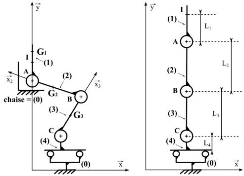
1) A partir du schéma cinématique ci-dessus, réaliser le graphe de liaison du système faisant intervenir les solides 0,
