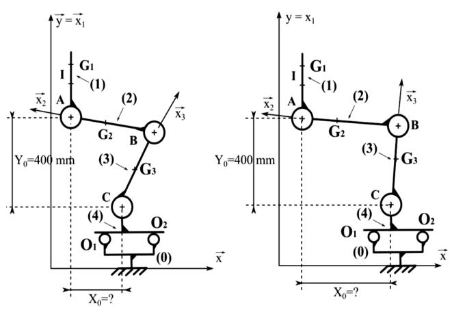
On donne les torseurs d'actions mécaniques des liaisons sphère/plan en O<sub>1</sub> et O<sub>2</sub>.
