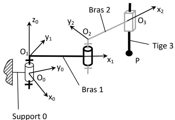
Dans cette étude, le châssis de ROBOVOLC constitue le bâti 0 auquel on associe un repère (fixe)  $(O_0, \vec{x}_0, \vec{y}_0, \vec{z}_0)$ . On suppose par la suite que le sol est plan et horizontal ; la direction  $\vec{z}_0 = \vec{z}_1 = \vec{z}_2$  correspond donc à la verticale. On suppose également que le référentiel lié au bâti est galiléen.
