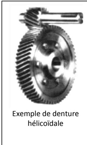
Exemple de denture hélicoïdale
