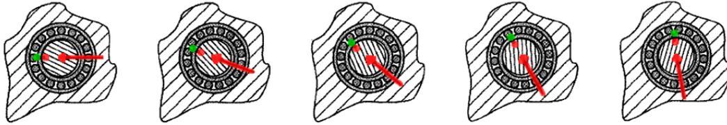
Figure 35 : Bon serrage : bague extérieure serrée
